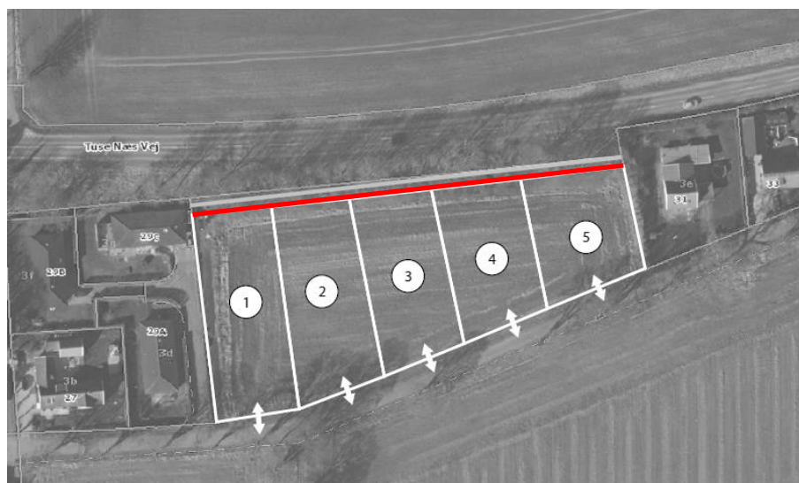
Figur 3: Scenarie 2 med 1,5 m høj støjskærm (indtegnet rød streg).
