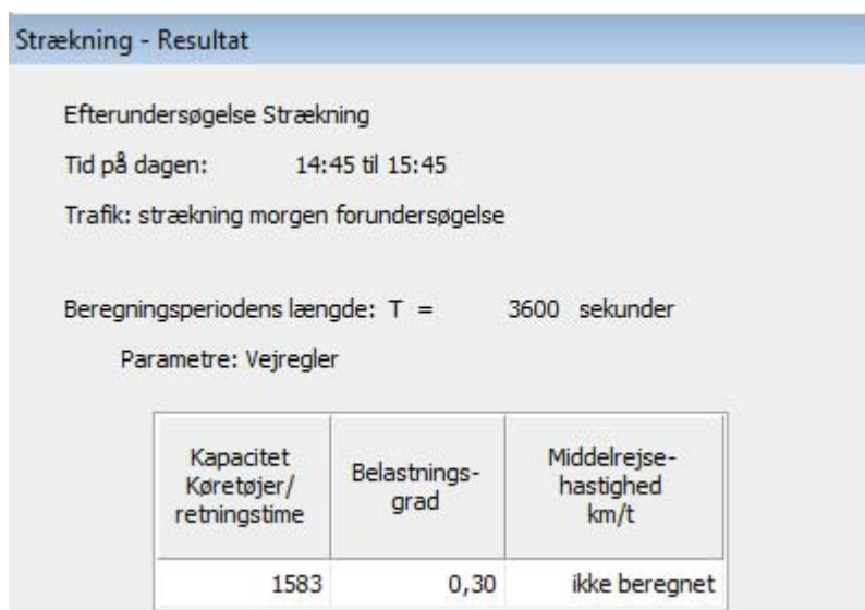
Figur 3 Kapacitetsberegning på strækning, fremtidige trafikforhold
