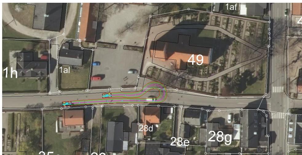
Figur 4-3 Principskitse ved vejlukning med vendeplads for personbiler.
