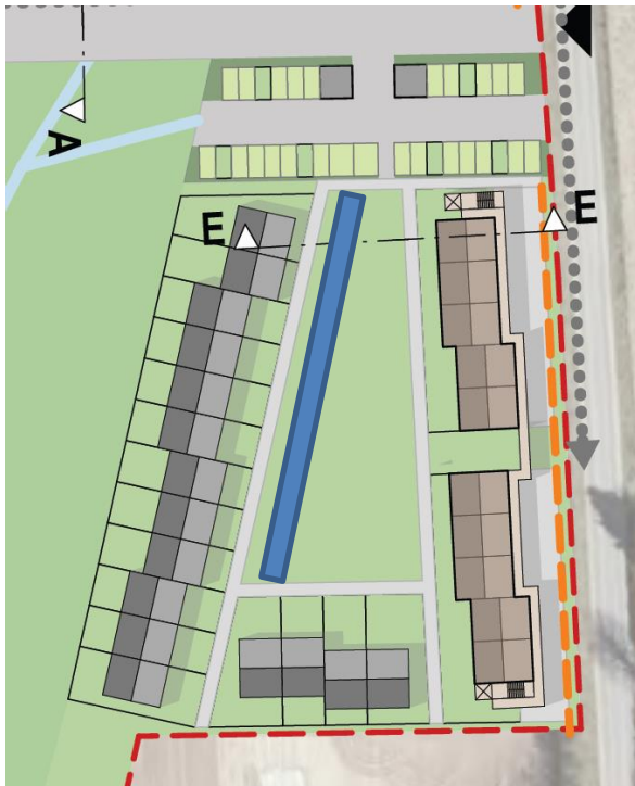
Figur 5 – Illustration af hvordan faskiner kan placeres (den blå markering).
