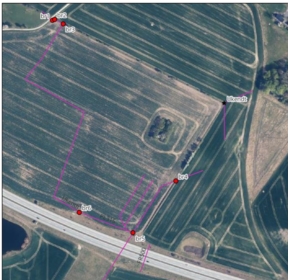
Figur 10-2 Opmåling af drænsystemet på Energibyens areal (Fors 2024)
