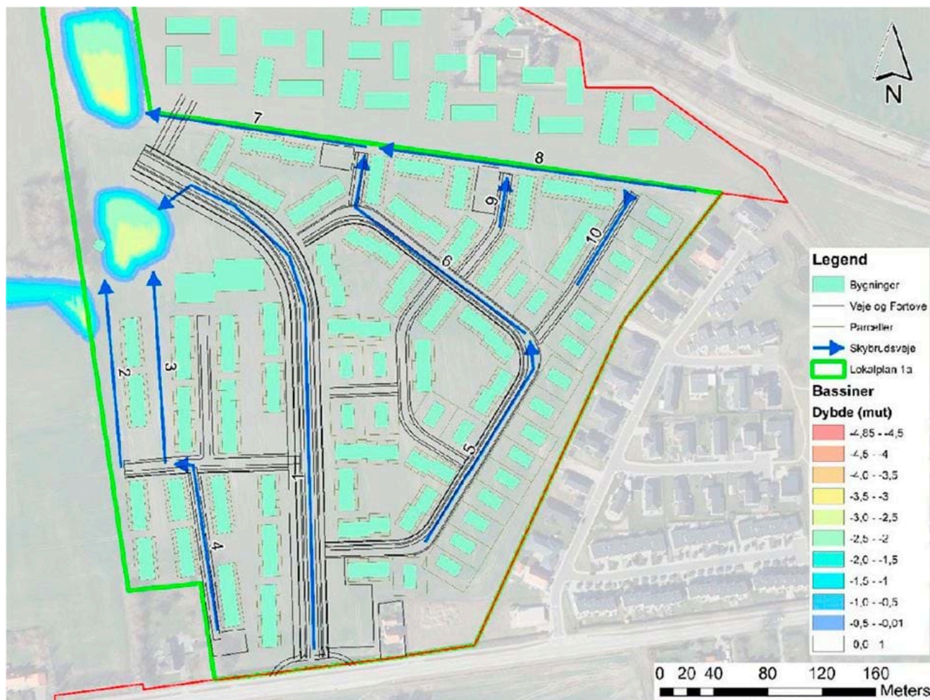
Figur 79: Placering af skybrudsveje inden for delområde 1, 2 og 4. Skybrudsveje 2, 3, 7 og 8 er grøfter. Terrænet i området falder mod nord. Regnvand der falder i nordlig retning opsamles i grøft og ledes til bassin 7.
